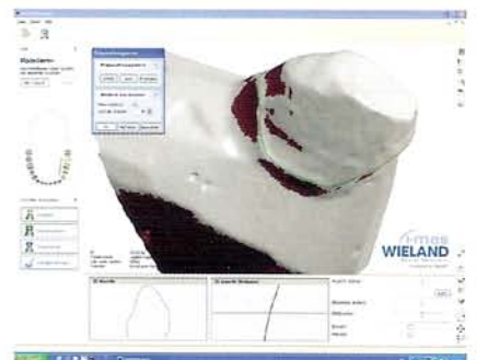
Unterschnitte werden automatisch erkannt und rot angezeigt. Kein Ausblocken mit Wachs oder Kunststoff und auch kein Auftrag eines Spacerlackes mehr notwendig
