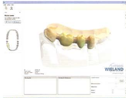
Die Brückenverbinder können individuell und einfach konstruiert werden. Bild rechts: Das gelbe Feld zeigt Form und Größe des Verbinders an und sichert eine qualitätsstabile Herstellung der Brückengerüste. Bild links: Brücke mit gescanntem Biss. Der dargestellte Gegenbiss und auch das Modell lassen sich in der Transparenz verändern. Eine komfortable Erleichterung beim Konstruieren.
