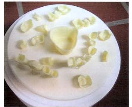
Zirkonoxidgerüste nach dem Sintern
