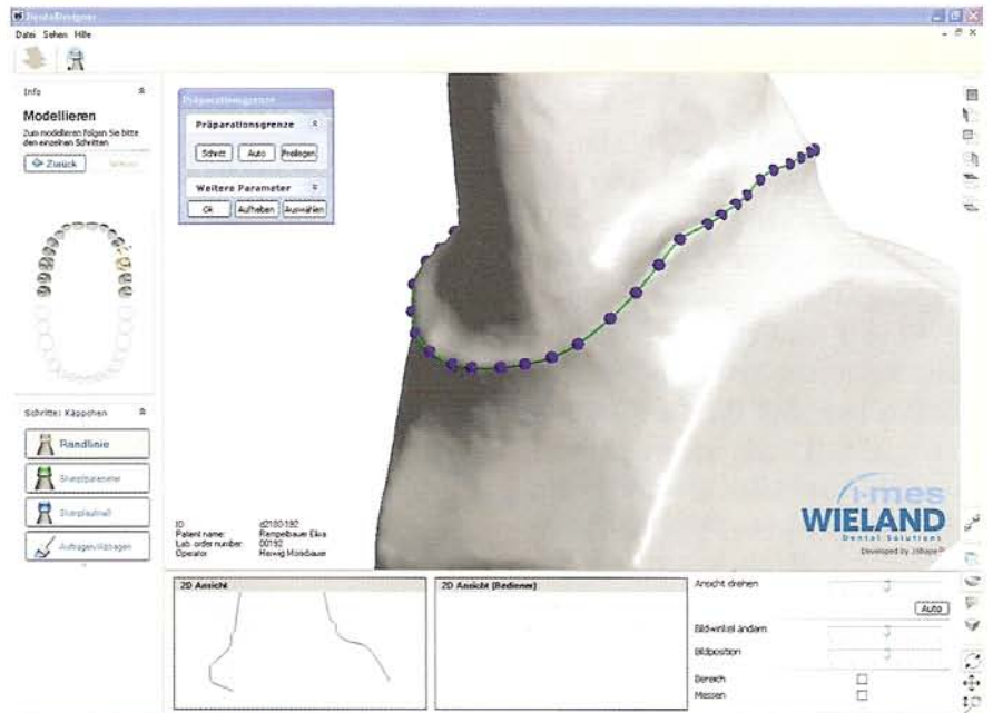
Korrektur der vom DentalDesigner™ automatisch erkannten Präparationsrandlinie
