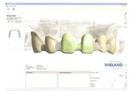
Brückengerüst im Bearbeitungsmodus
