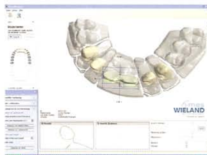
Feineinrichten der im Artikulator definierten Position
